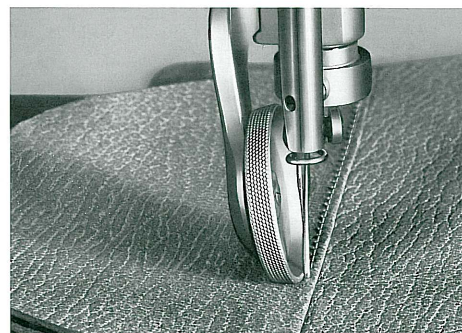
Adler 67-82 S, -FA 82 S: Blattstepperei Stitching a vamp Piquage d'un quartier Pespunteando una pala
