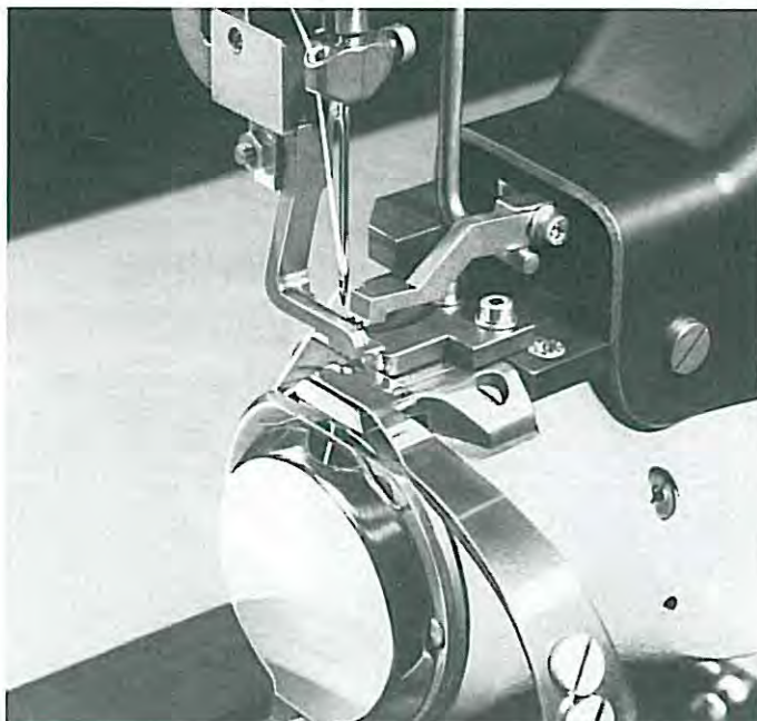
Adler 205 MO-2-2 Spezialnähgarnitur mit Trennzunge, Mehrweitenverteiler und Legefingern
