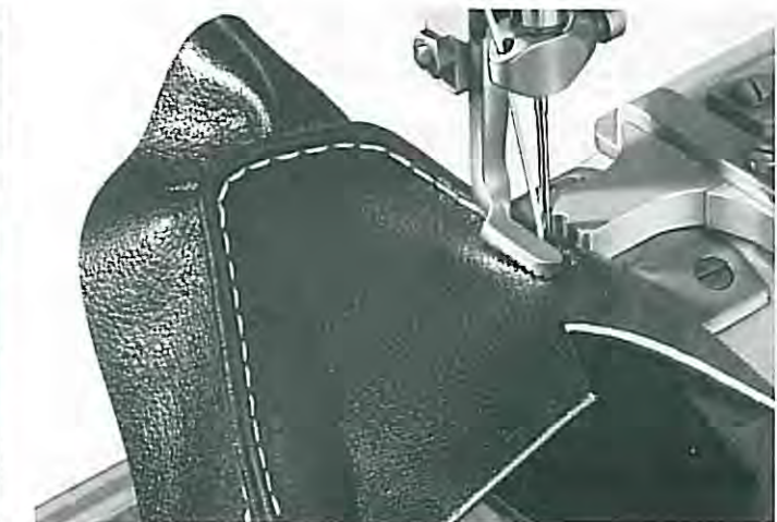
Adler 205-25 Steppen einer Wulstnaht mit Spezialanschlaglineal GF 235 Stitching a bead seam with guide GF 235 Piquage d'un bourrelet à l'aide du guide spécial rectiligne GF 235 Costura de abombamiento con tope especial GF 235
